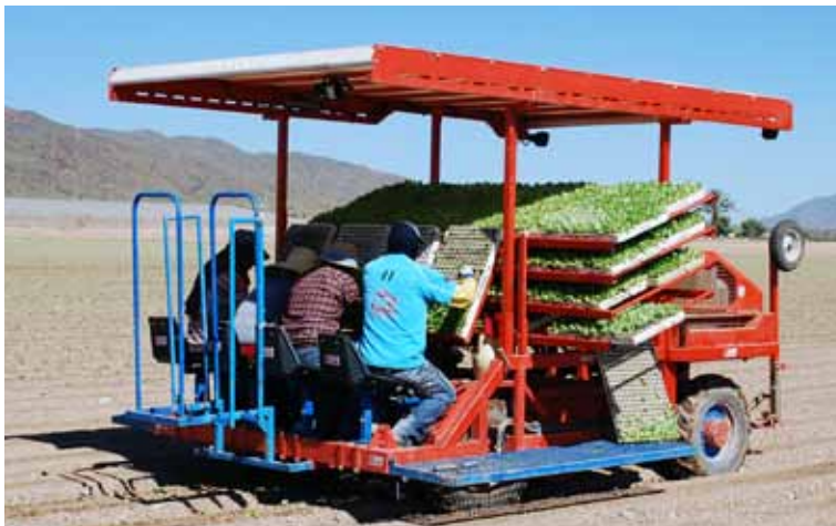
Figura 4. Plantadora autopropulsada de lechugas, observar la franja de humedad en la mesa, con la línea de goteo enterrada
