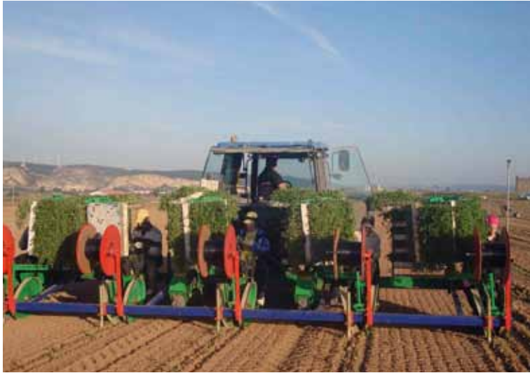
Figura 5. Plantadora sobre suelo sin acolchar
