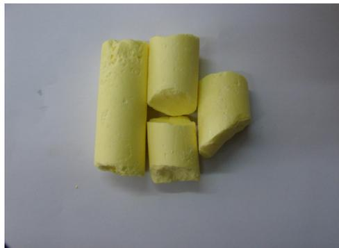
Figura 7. Vista de las pastillas de azufre utilizadas en los sublimadores
