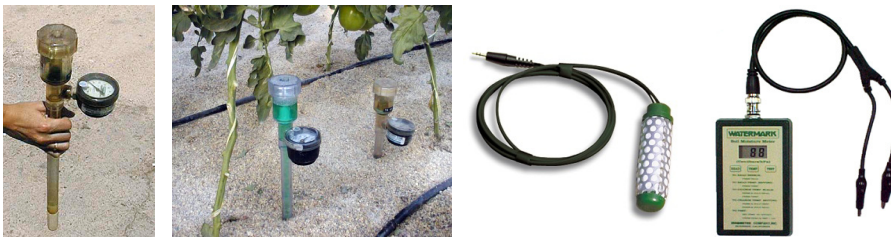
Figura 2. Un tensiómetro manual e instalado en suelo arenado, un sensor watermarky su lector
