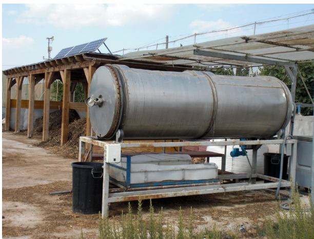
Figura 5. Compostera rotativa diseñada por la Fundación Cajamar
