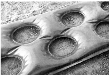
Figura 4: Almacenamiento sensible en bolsas de PE negras utilizadas como captadores solares
