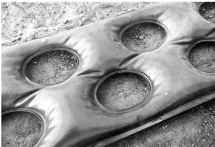
Figura 4: Almacenamiento sensible en bolsas de PE negras utilizadas como captadores solares
