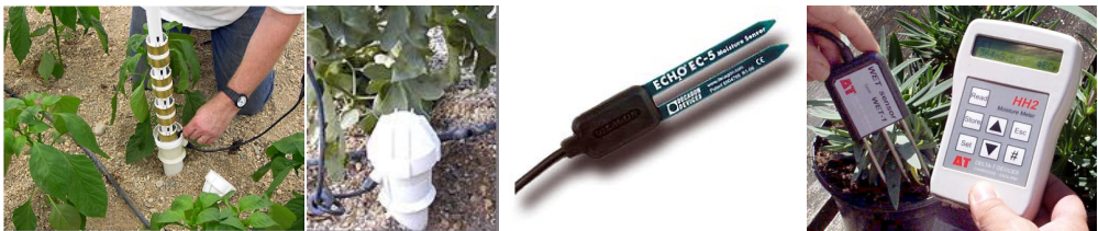
Figura 3. Sensores de capacitancia. Varios sensores EnviroSCAN dispuestos en una sonda, una sonda EnviroSCAN instalada en suelo, un sensor ECHO y el WET sensor con lector
