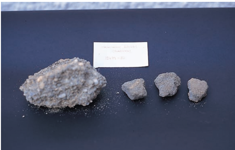
67. Compactación de arenas de enarenado por formación de fosfatos cálcicos. Zona El Alquíán - La Cañada
