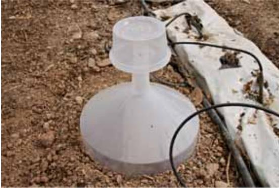
**Figura 24.** Embudo colocado sobre el suelo, con un recipiente superior donde se acumulan las polillas adultas que eclosionan y se mueven hacia arriba por su comportamiento natural. El embudo tiene un diámetro de 30 cm.
