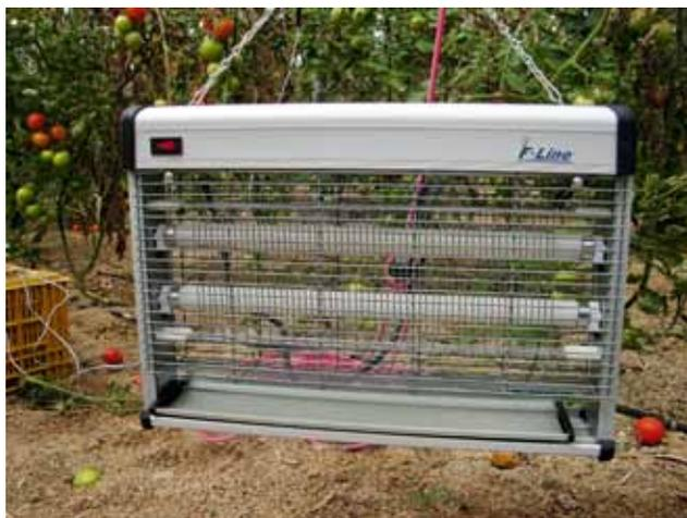
**Figura 22.** Trampa rectangular. Alrededor de los tubos fluorescentes se electrocutan las polillas en una parilla bajo tensión. 'F-Line insect killer' EMTIN 60038. Potencia total: 38 W. Contiene dos tubos fluorescentes G13 de 15 W. Dimensiones: 30 x 40 x 8,5 cm.
