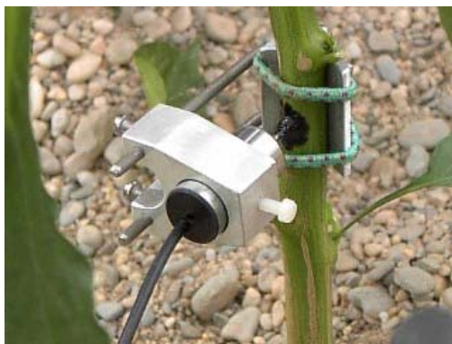
Foto 1: Detalle de un sensor de medida del diámetro del tallo en pimiento.
