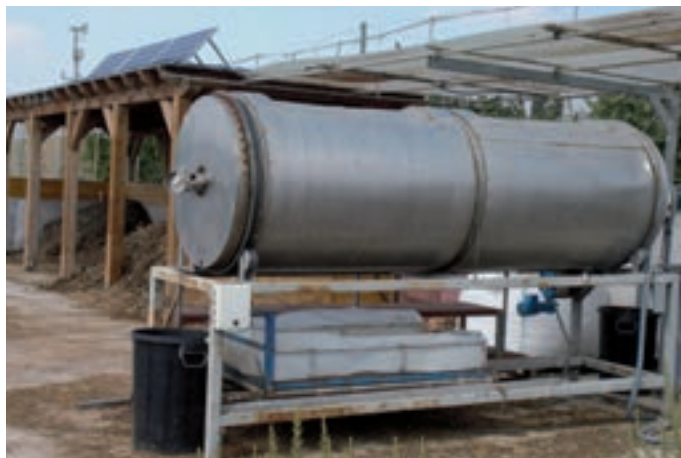
Figura 3. Compostera rotativa diseñada por la Estación Experimental de Cajamar ‘Las Palmerillas’
