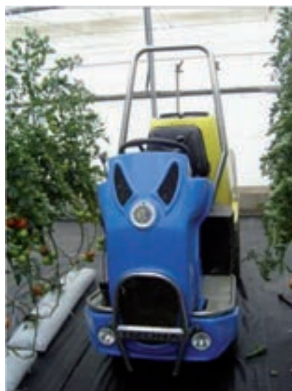
Figura 4. Equipo de barras verticales (Tizona®)
