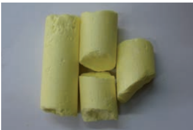
Figura 4. Cilindros de azufre utilizadas en los sublimadores
