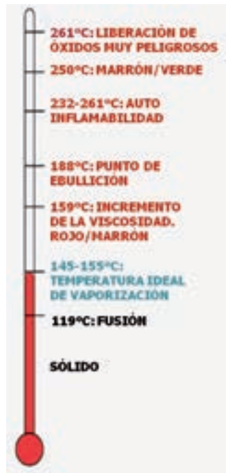
Figura 3. Temperaturas de funcionamiento en un sublimador
