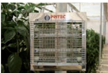
Figura 9. Vista de la trampa de luz ultravioleta
