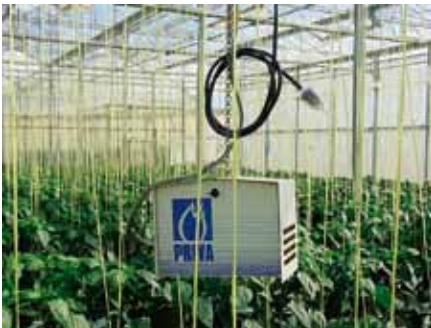
Fotografía 2.19 Vista exterior y detalle del interior del psicrómetro ventilado usado durante el experimento.
