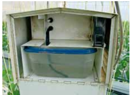
Fotografía 2.19 Vista exterior y detalle del interior del psicrómetro ventilado usado durante el experimento.
