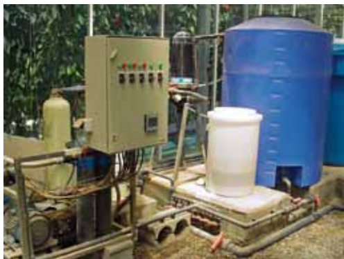
Fotografía 2.14 Vista del cabezal del sistema de nebulización usado durante el experimento.
