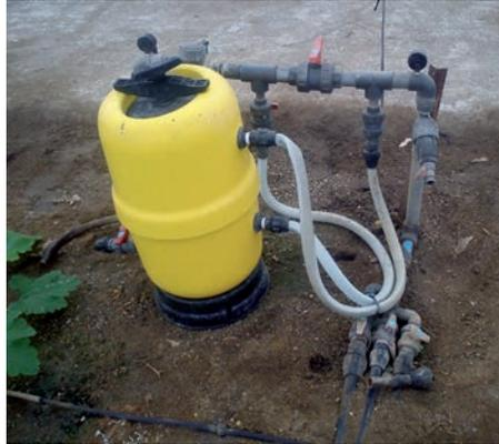
Para conseguir la entrada de la disolución en la red se utiliza una válvula que se puede cerrar progresivamente hasta conseguir una diferencia de presión a la entrada y la salida del depósito que permita desviar parte del flujo a través del depósito. Este sistema es el más económico, aunque puede provocar diferencias en el crecimiento de las plantas por su baja uniformidad de distribución, ya que la inyección en la red no se realiza de forma proporcional al caudal de riego.
