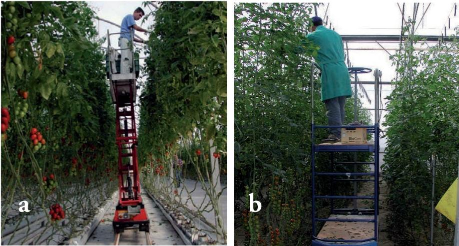
**Figura 122. Carros para transporte de cajas entre líneas de cultivo (a) y para transporte y apoyo del operario (b)**
