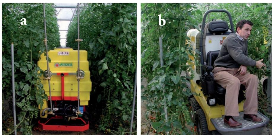
Estos equipos están constituidos básicamente por un vehículo autónomo con motor eléctrico, un depósito del líquido de tratamiento, una bomba de impulsión hidráulica, y dos barras porta-boquillas. En general, estos sistemas permiten un adecuado control de la velocidad de avance y del caudal de tratamiento, por lo que mejora su eficacia con respecto a las redes fijas.
