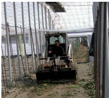
Las estructuras que se construyen actualmente tanto para los invernaderos tipo Almería, como para los tipos de estructuras de perfiles metálicos (multitúnel y *venlo*), facilitan la introducción de maquinaria al aumentar la distancia entre apoyos hasta 6-9 m.
