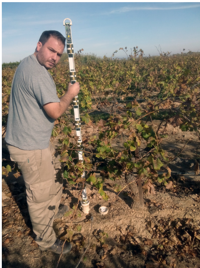
Figura 18. Imagen de una sonda capacitiva multisensor instalada en un viñedo
