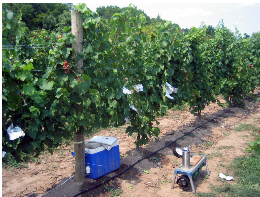
Figura 19. Imagen de una cámara de presión y de hojas de vid embolsadas para determinación del potencial hídrico de hoja embolsada o de tallo
