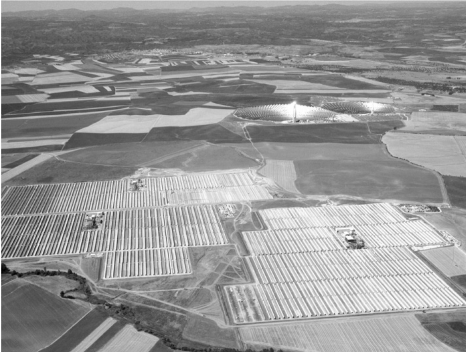
Figura 2. Vista panorámica de la plataforma solar de Abengoa Solar en Sanlúcar la Mayor (Sevilla) En primer plano, tres plantas de producción de energía eléctrica de origen termosolar con colectores cilíndrico parabólicos. Al fondo, dos plantas comerciales de torre y una menor dedicada a actividades de I+D.
