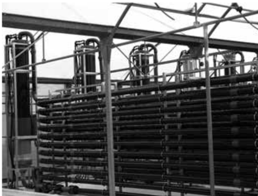
Figura 2. Imagen de fotobiorreactor tubular de 3 m 3 como ejemplo de reactor cerrado. Reactores instalados y operados en la Estación Experimental Cajamar
