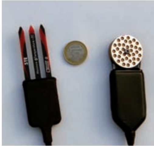
Figura 3. Sensores ECH 2 O 5TE (izda.) y MPS2 (dcha.)
