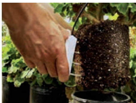
Figura 7. Instalación de una sonda GS3 en un sustrato de fibra de coco y sonda Grodan WCM sensor de medida de humedad, temperatura y conductividad eléctrica diseñado para lana de roca
