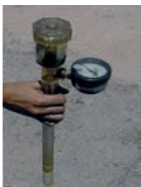
Figura 3. Tensiómetro manual antes de su instalación (izda.), tensiómetro provisto de transductor de presión (centro) y sensor de matriz granular Watermark con la unidad de medida (dcha.)
