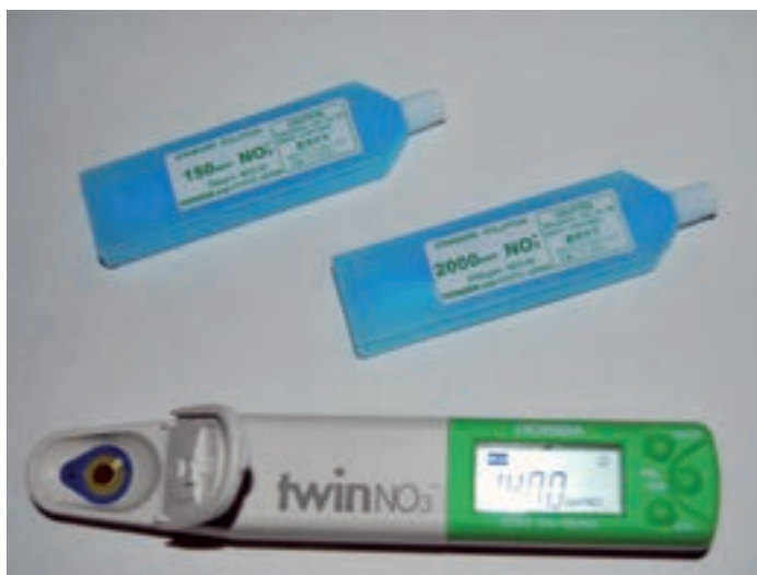
Figura 1. El metro LAQUAtwin con las soluciones de calibración. A la izquierda se muestra el depósito donde se colocan las soluciones a medir. Existen modelos que permiten medir \text{Ca}^{2+} , \text{K}^+ , \text{Mg}^{2+} , \text{Cl}^- y \text{Na}^+
