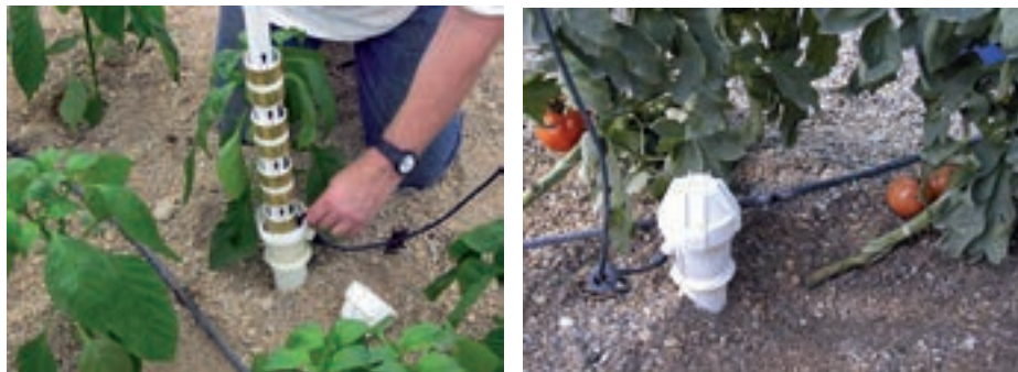
Figura 4. Equipo FDR de capacitancia EnviroScan antes (izquierda) y después de su instalación en el invernadero. En la fotografía de la izquierda se muestran los 4 sensores insertados en una sonda vertical
