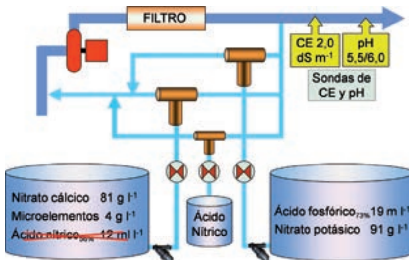
Figura 10. Incorporación de la SN con ajuste automático de los caudales de inyección por medición de la CE y del pH
