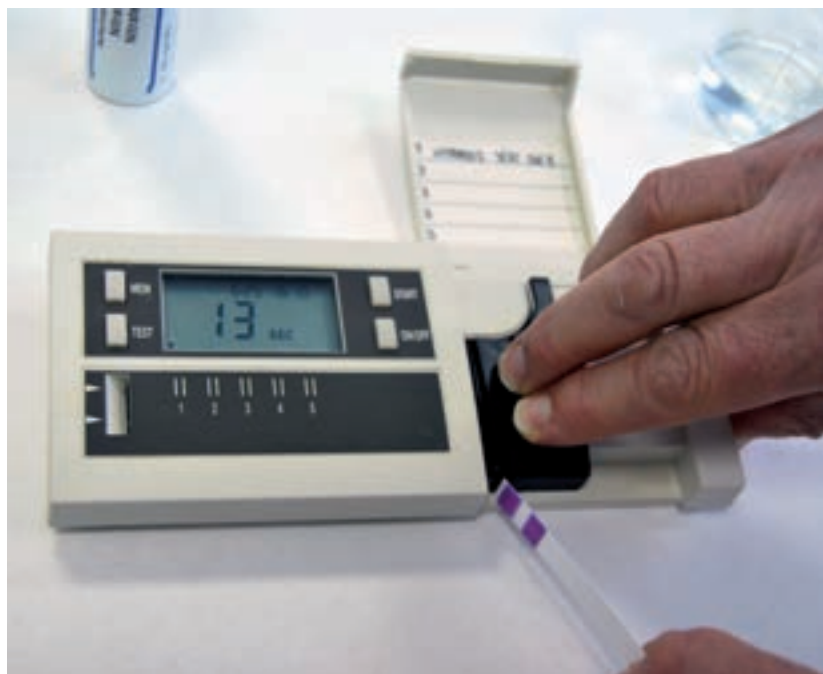
Figura 4. Medida con el RQ Flex reflectómetro Merck. La tira se introduce en el equipo para tomar la medida
