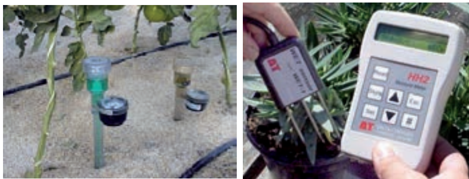
Figura 1. Instalación semipermanente de tensiómetros en un invernadero con suelo enarenado y cultivo de tomate (izda.) e instalación puntual de un sensor de capacitancia en planta ornamental (dcha.)
