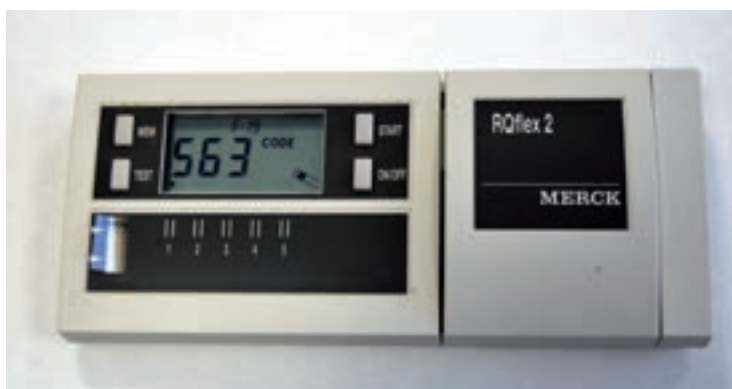
Figura 3. Aspecto exterior del RQ Flex reflectómetro de Merck
