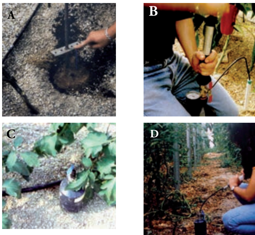
Figura 5. Instalación (A), carga (B), ubicación en campo (C) y toma de muestras de la disolución del suelo mediante sondas de succión (D)
