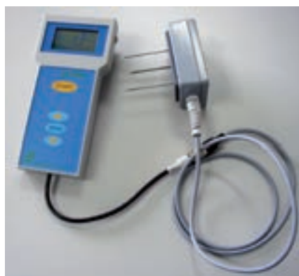
Figura 7. Instalación de una sonda GS3 en un sustrato de fibra de coco y sonda Grodan WCM sensor de medida de humedad, temperatura y conductividad eléctrica diseñado para lana de roca
