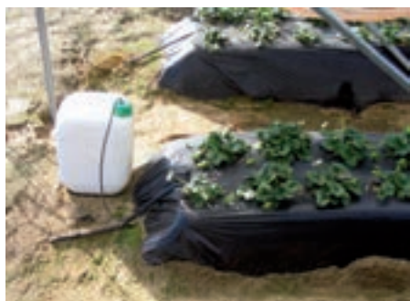
Figura 13. Sondas de succión instaladas a diferente profundidad, toma de muestras de la solución nutritiva fertilizante y extracción de la solución captada por la sonda de succión
