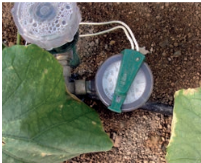
Figura 2. Tensiómetro equipado con un relé-selector que posibilita la activación del riego
