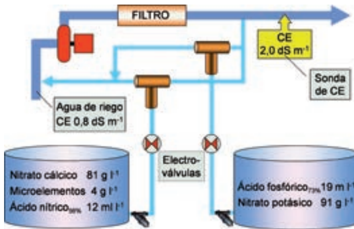
Figura 8. Incorporación de la SN con ajuste automático del caudal de inyección por medición de la CE
