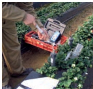
Figura 13. Sondas de succión instaladas a diferente profundidad, toma de muestras de la solución nutritiva fertilizante y extracción de la solución captada por la sonda de succión
