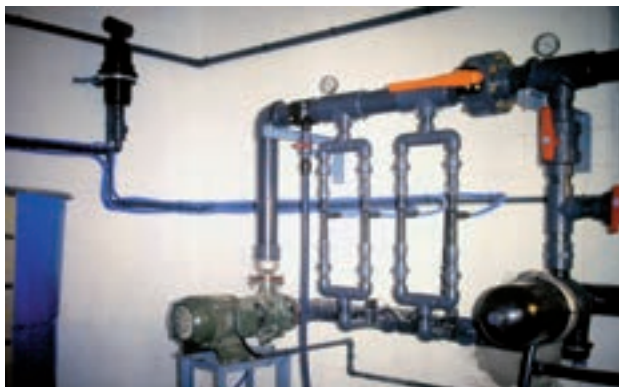
Figura 5. Incorporación de la SN concentrada «n» veces (150) con ajuste manual del caudal de inyección
