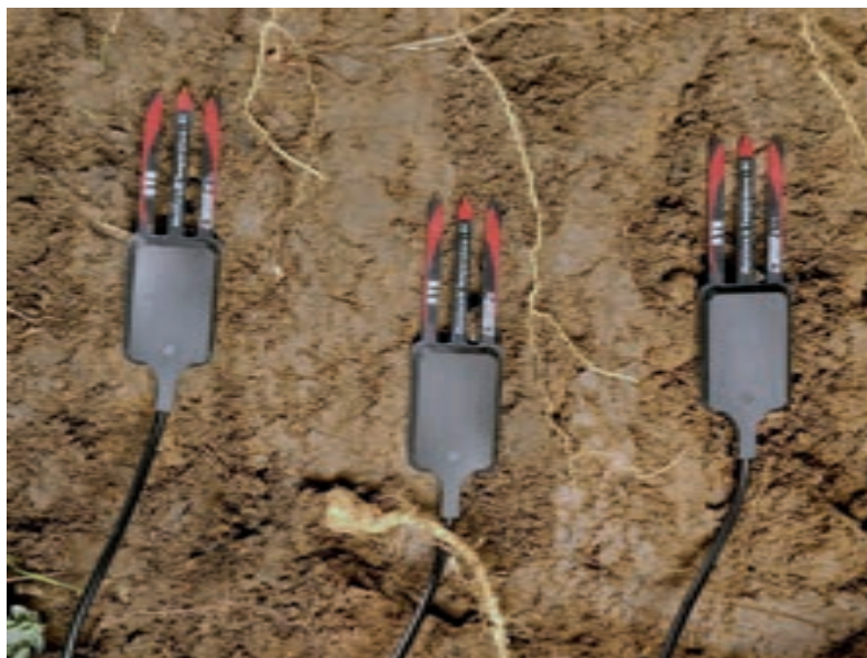
Figura 5. Sondas ECH 2 O Instaladas a tres profundidades de suelo para medir humedad volumétrica, temperatura de suelo y conductividad eléctrica en distintos medios de cultivo
