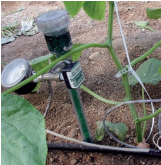
Figura 1. Electrotensiómetro equipado con un transductor de presión que permite la medida del potencial matricial en continuo
