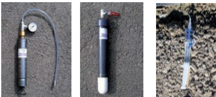
Figura 10. Sonda de succión, equipo complementario de extracción y extractómetro capilar para extraer la solución del suelo
