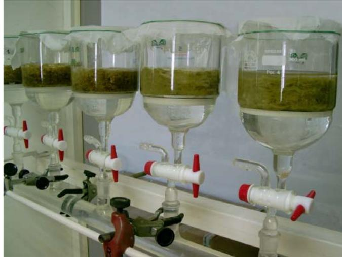
Figura 3. Batería de muestras de lana de roca para la determinación de curvas de retención de agua.
