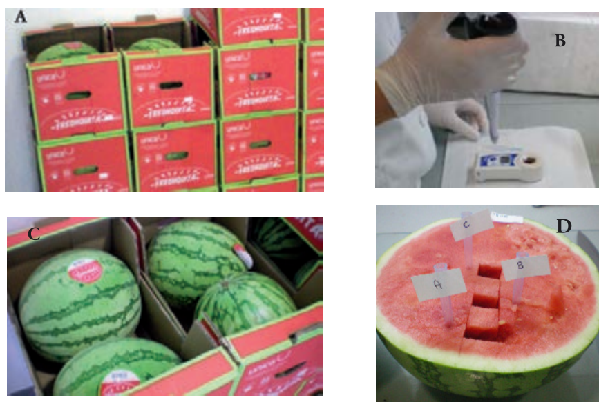
Figura 2. Recepción de muestras: sandías (A) y (C). y análisis de referencia de zonas de análisis de °Brix y color interno de la sandía (B) y (D)
