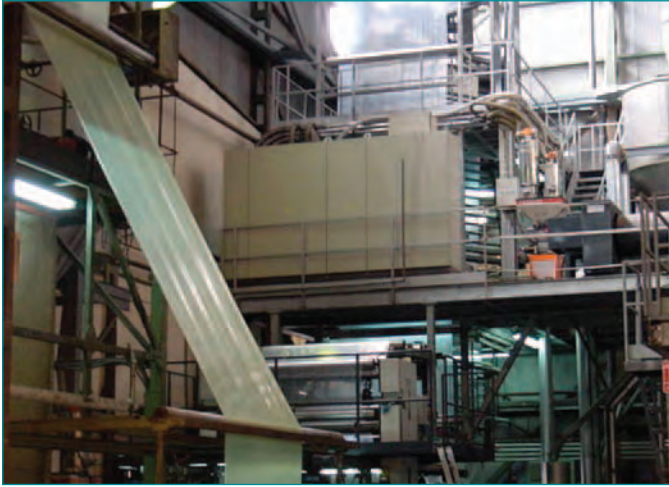
TRANSFORMACIÓN DE LA GRANZA EN PELÍCULA PLÁSTICA.
